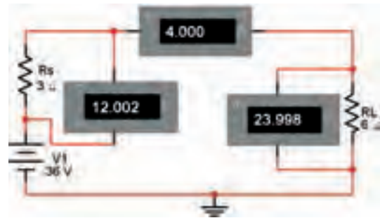
شکل ۱-۱۶ اندازه‌گیری مقادیر ولتاژ و جریان
