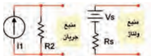
شکل ۱-۱۷ تبدیل منبع ولتاژ به منبع جریان
