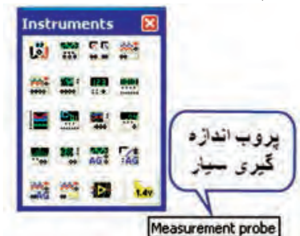
شکل ۱-۸ انتخاب پروب اندازه‌گیری سیار
