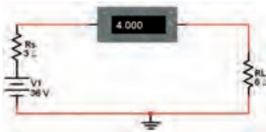
شکل ۱-۱۵ منبع ولتاژ و مقاومت داخلی آن
