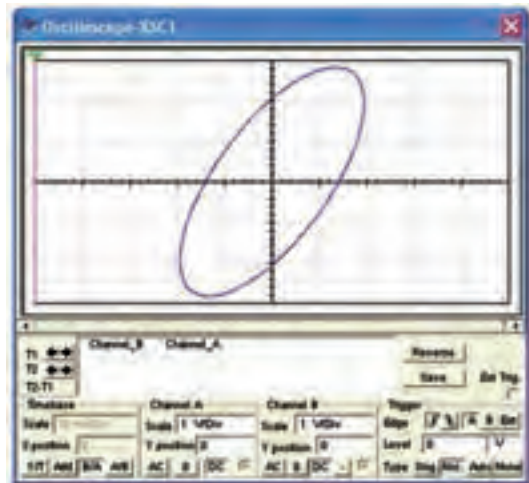
شکل ۳-۳ منحنی اختلاف فاز مدار RC سری
