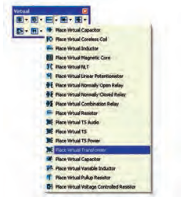
شکل ۴-۳ نحوه‌ی استفاده از نوار Virtual برای آوردن ترانسفورماتور روی صفحه‌ی کار
