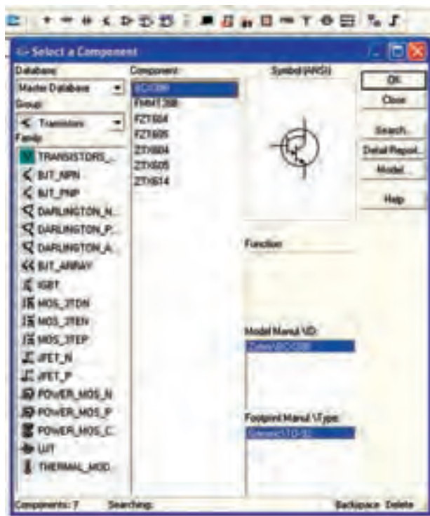
شکل ۴-۱۱ نحوه‌ی قراردادن ترانزیستور زوج دارلینگتون
