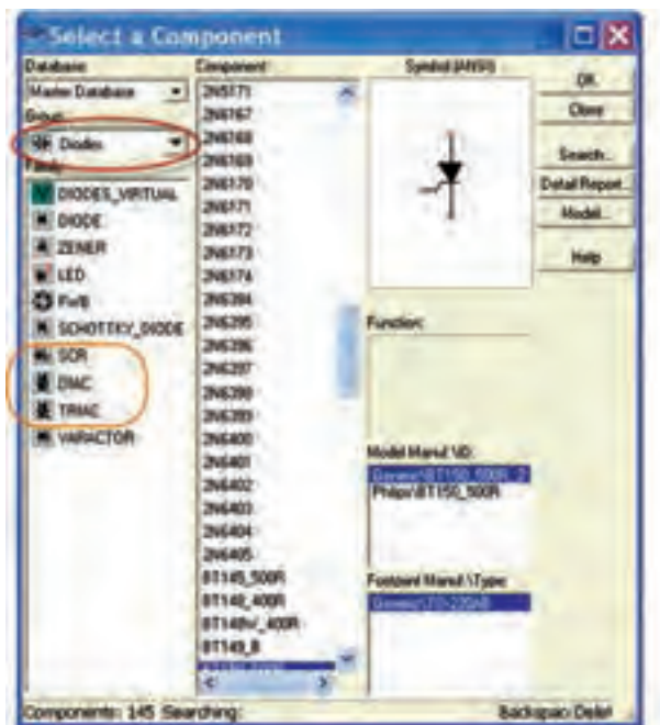
شکل ۱-۸ مسیر انتخاب قطعات الکترونیک صنعتی
