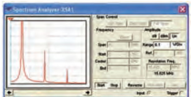
شکل ۱-۱۷ هارمونیک‌های موج مثلثی با فرکانس ۶۰۰ مگاهرتز
