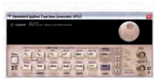
شکل ۲-۲ نمای ظاهری دستگاه فانکشن ژنراتور
