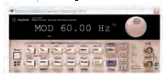
شکل ۲-۱۵ چگونگی تنظیم شاخص مدولاسیون در حالت FM
