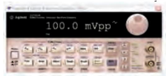
شکل ۲-۱۴ دستگاه فانکشن ژنراتور در حالت FM
