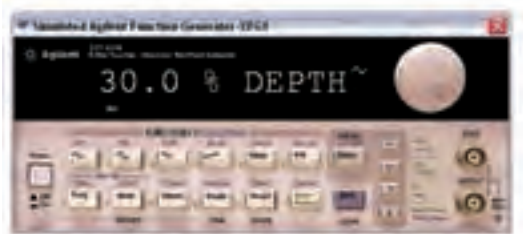
شکل ۵-۲ تنظیم درصد مدولاسیون در حالت AM
