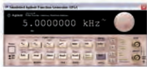
شکل ۴-۲ تنظیم فرکانس در حالت AM
