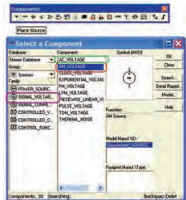
شکل ۵-۱۴ مسیر دسترسی به سیگنال ژنراتورهای صوتی و مدار سیگنال AM
