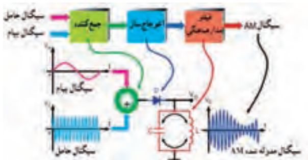
شکل ۵-۱-۵ بلوک دیاگرام مدولاتور دیودی AM
