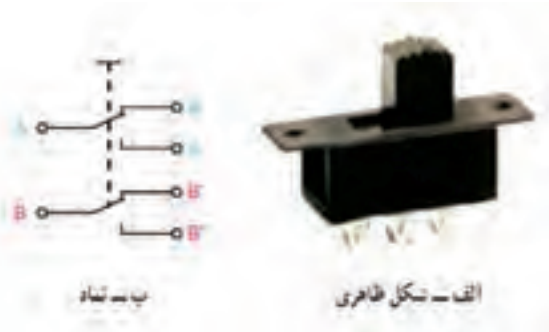
شکل ۶-۱ تصویر کلید تبدیل دوبل و نماد فنی آن
