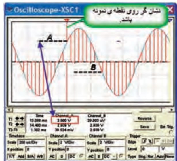
شکل ۷-۳ اندازه‌گیری دامنه‌ی دو نمونه پالس
