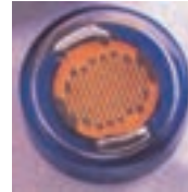
شکل ۱-۱۴- نمای ظاهری و علامت اختصاری یک فتورزیستور
