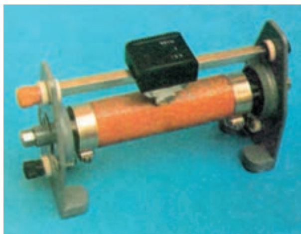
ب - مقاومت سیمی متغیر (رئوستا)
