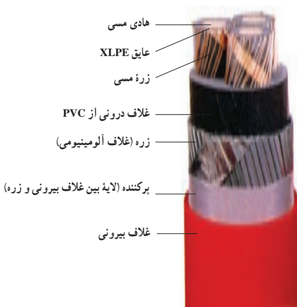
شکل ۲-۶- کابل با غلاف آلومینیومی
