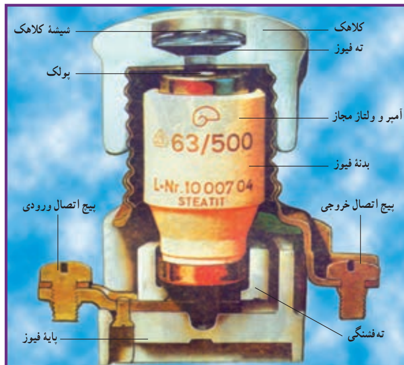
شکل ۱۵-۴- نمای بُرش خورده فیوز فشنگی
