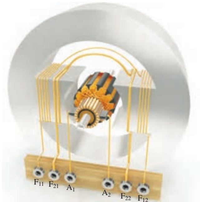
شکل ۳-۳۵ طرح ساختمانی ژنراتور کمپوند
