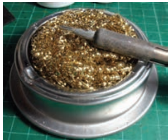
شکل ۱-۴۳- یک نمونه دیگر از اسفنج مخصوص تمیز کردن نوک هویه
