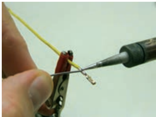
شکل ۱-۵۰- لحیم کاری به کمک گیره
