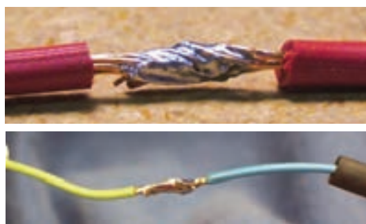
شکل ۱-۵۴- دو نمونه لحیم کاری قابل قبول
