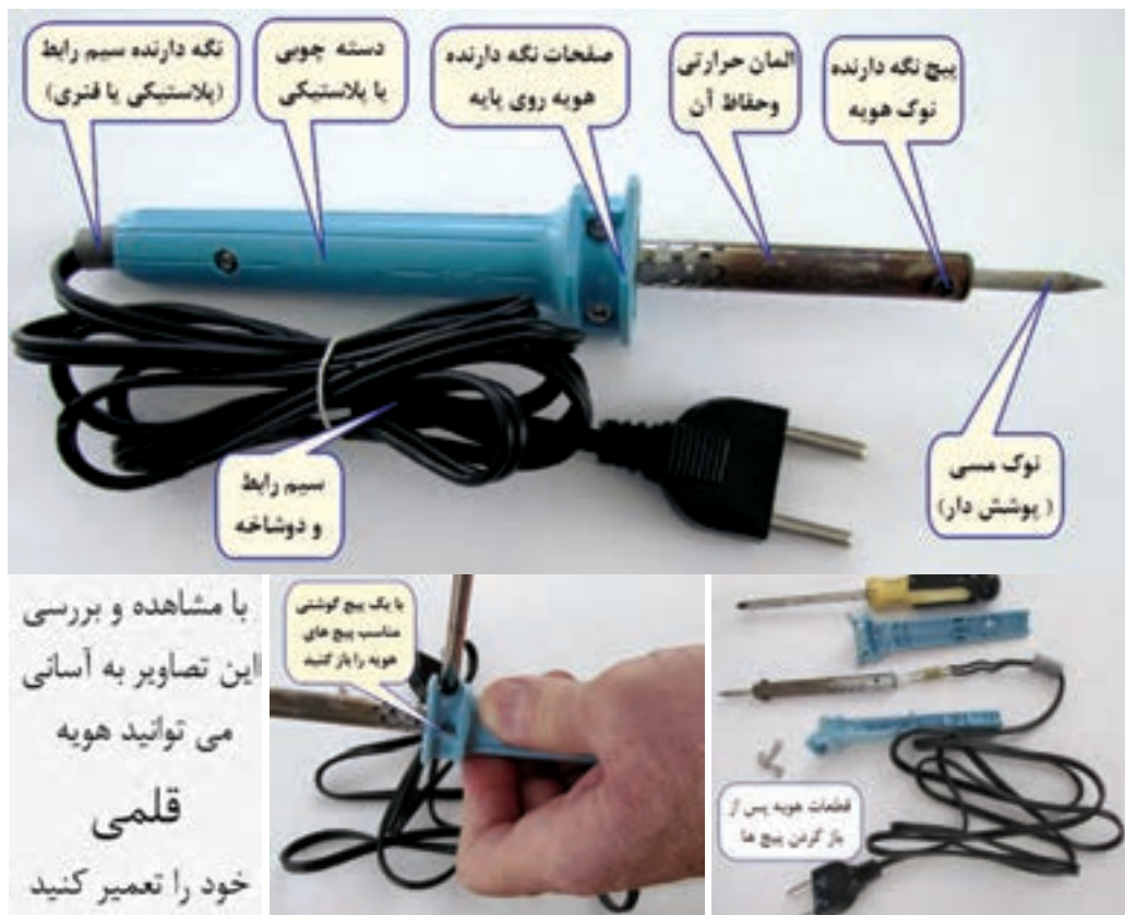
شکل ۲۷-۱- قسمت‌های مختلف یک هویه قلمی
