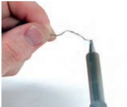
شکل ۱-۴۰- اضافه کردن لحیم به نوک هویه
