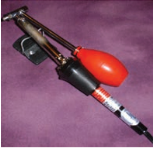
شکل ۱-۶۶- نمونه ای از قلع کش حرارتی با پمپ دستی
