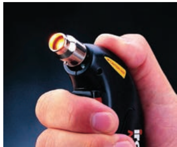
شکل ۱-۶۲- دستگاه گرم کن برای وارنیش حرارتی
