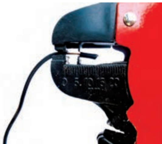
شکل ۱-۴۹- لخت کردن سیم
