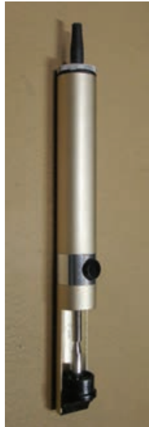
شکل ۱-۶۵- دو نوع قلع کش پیستونی
