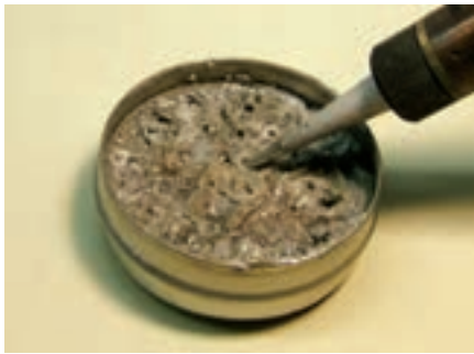
شکل ۱-۳۹- فرو کردن نوک هویه در روغن لحیم
