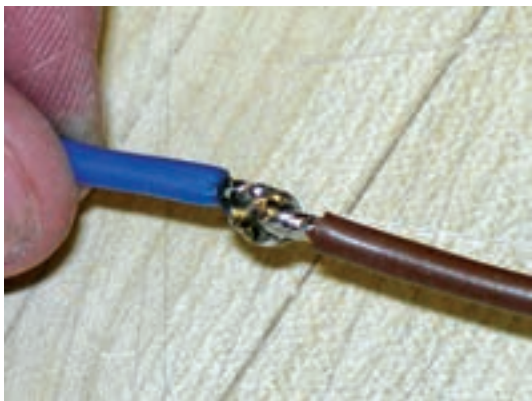
شکل ۱-۵۵- نمونه دیگری از لحیم کاری قابل قبول
