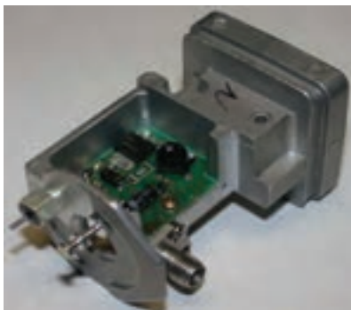
شکل ۲۹-۲ LNB و مدار داخل آن
