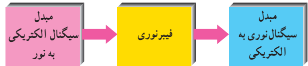
شکل ۲-۸- اساس یک سیستم فیبر نوری
