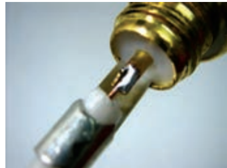
شکل ۱-۹۷- اتصال کابل کوآکسیال به BNC
