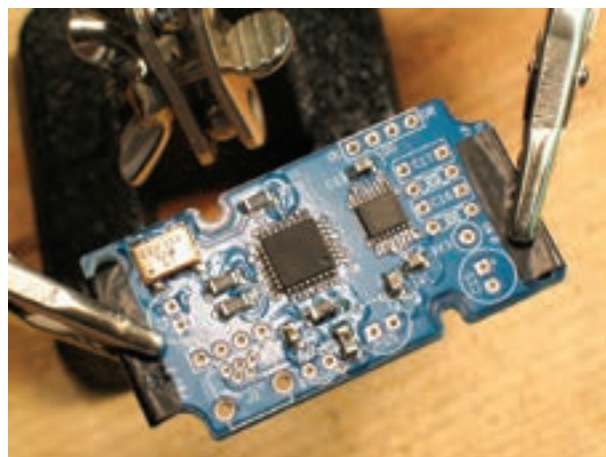
شکل ۷۹-۱- نمونه دیگری از پایه لحیم‌کاری
