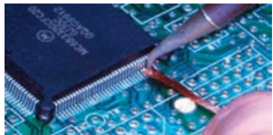
شکل ۱-۷۵- جدا کردن آی سی با فتیله لحیم
