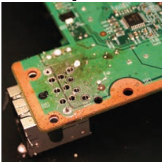
ب) برداشتن لحیم‌ها و آزاد کردن پایه‌ها
