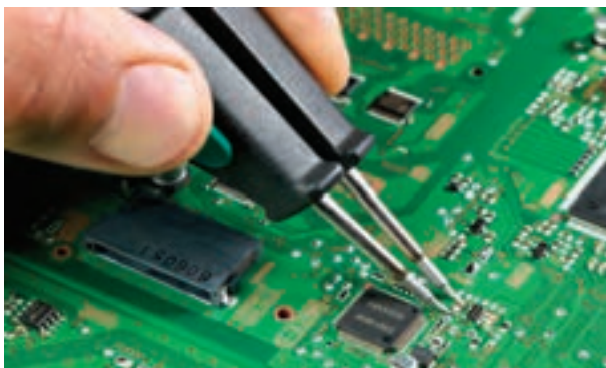
شکل ۸۸-۱- استفاده از هویه پرسی شکل
