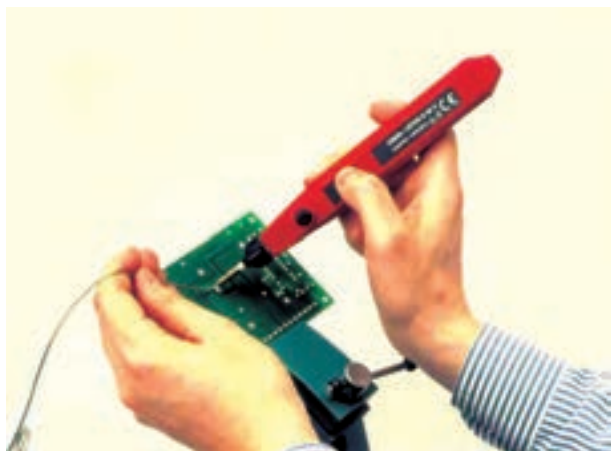
شکل ۸۳-۱- نوع دیگری از لحیم کاری روی بُرد مدار چاپی
