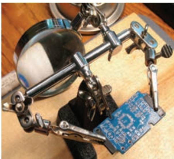
شکل ۱-۷۸- یک نمونه پایه لحیم کاری
