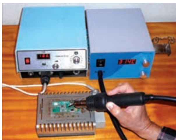
شکل ۸۶-۱- هویه با تنظیم دمای الکترونیکی
