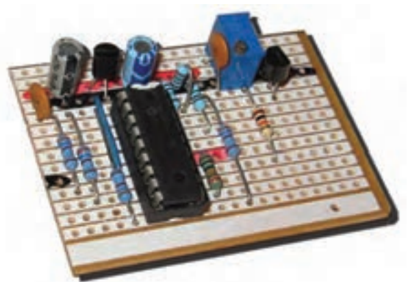
شکل ۱-۱۰۴- یک نمونه مدار کامل روی فیبر سوراخ‌دار
