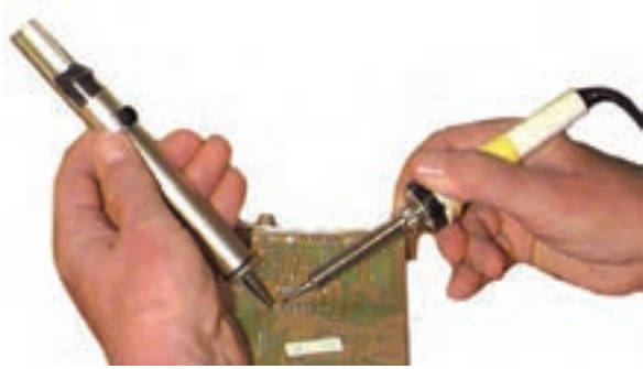
شکل ۱-۷۳- نمونه دیگری از کار قلع کش پیستونی
