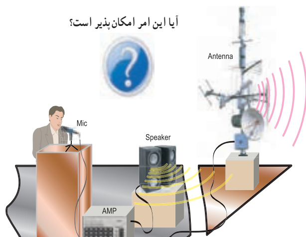
شکل ۷-۳ - تبدیل امواج صوتی به امواج الکترومغناطیسی
