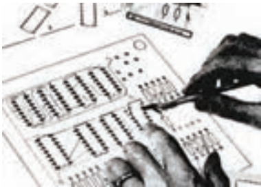
شکل ۲۹-۴- نحوه چسباندن لتراست مربوط به پایه قطعات
