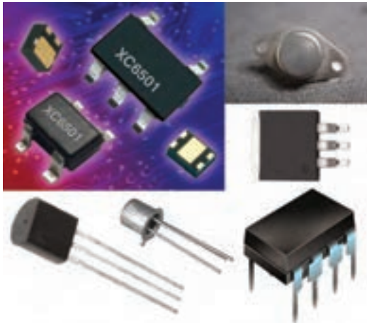
شکل ۲-۱۳- شکل ظاهری چند نمونه آی سی رگولاتور
