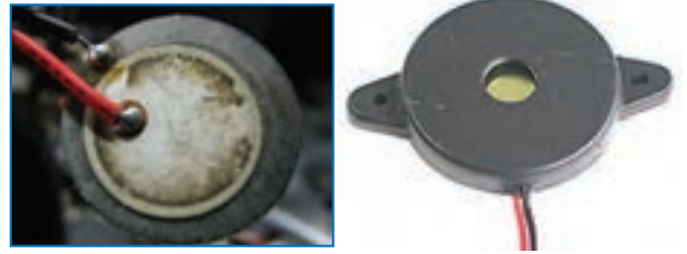
شکل ۹-۲۸ ساختمان داخلی و شکل ظاهری صفحه حساس پیزوالکتریک
