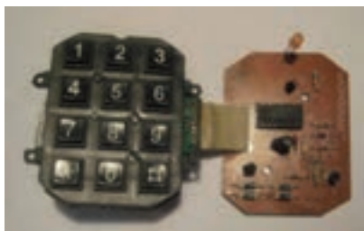
شکل ۹-۴ برد تلفن الکترونیکی و شماره‌گیر
