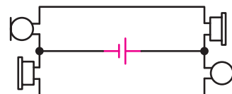
شکل ۹-۳۱ مدار مکالمه دو طرفه با یک باتری
