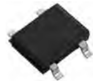
پل یک سو ساز در بسته بندی IC نصب سطحی
