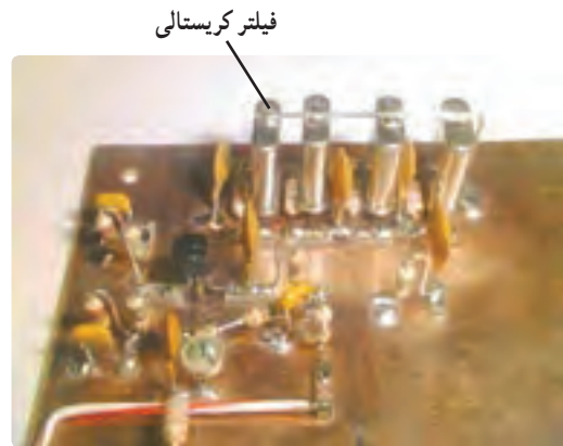
شکل ۱-۳۶- فیلتر کریستالی نصب شده روی مدار
