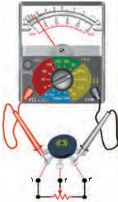
شکل ۱-۳۲- اندازه‌گیری مقدار کل مقاومت ولوم
