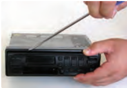
شکل ۲-۳۱- نحوه خارج کردن نادرست قاب
