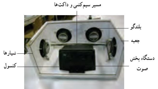
شکل ۲-۴۷- جعبه سیمولاتور با ۴ بلندگو
