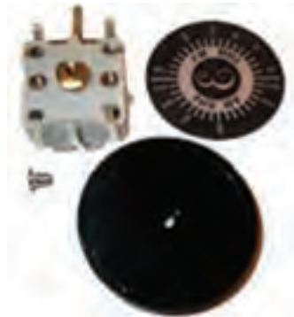
خازن متغیر و اجزای جانبی آن
