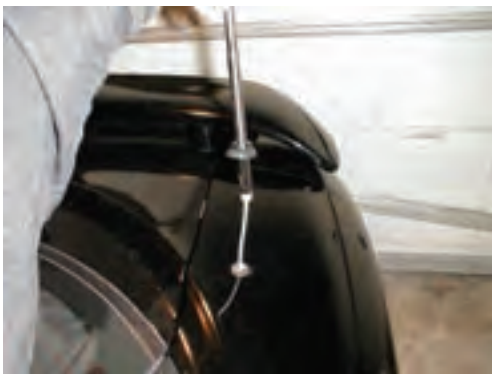
شکل ۲-۵۸- محل نصب آنتن اتومبیل
