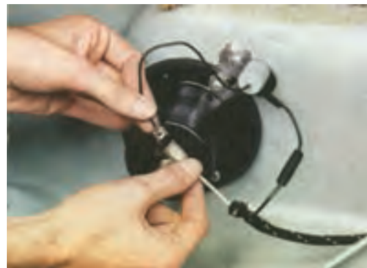
ب- محل پارازیت گیر در مسیر پمپ بنزین الکتریکی
