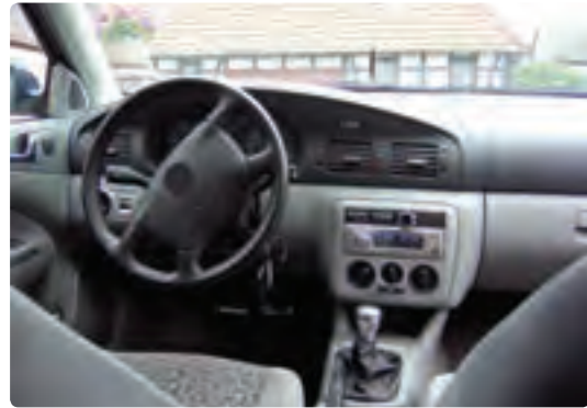
شکل ۲-۱- محل نصب رادیو پخش روی پانل جلویی
