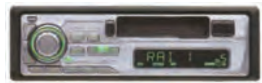
شکل ۲-۵- پانل پخش صوت با قابلیت جدا شدن
