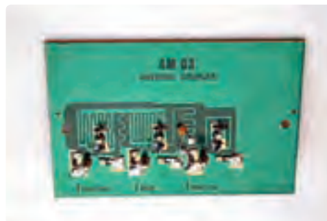
شکل ۴-۵- ترکیب کننده دو سیگنال و بُرد آن
