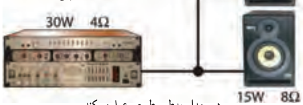
شکل ۵-۵ - اتصال بلندگو به خروجی تقویت کننده
