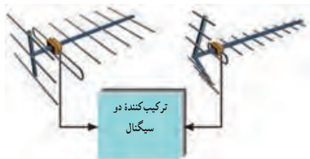
شکل ۴-۴- بلوک دیاگرام ترکیب‌کننده دو سیگنال
