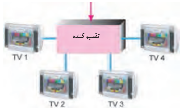
شکل ۴-۳۰ نقشه بلوکی تقسیم کننده
