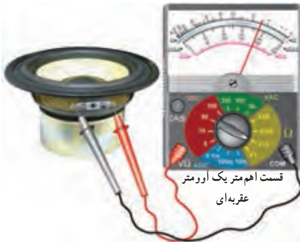
شکل ۵-۱۳- اندازه‌گیری مقاومت اهمی بلندگو با اهم‌متر
