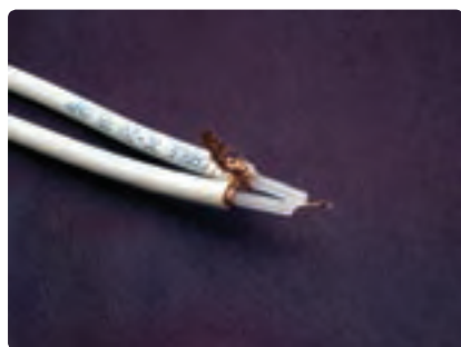
شکل ۴-۱۶- کابل نباید دو تکه باشد.
