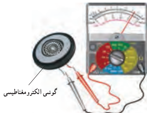
شکل ۵-۱۲- نحوه اتصال گوشه الکترومغناطیسی به اهم‌متر
