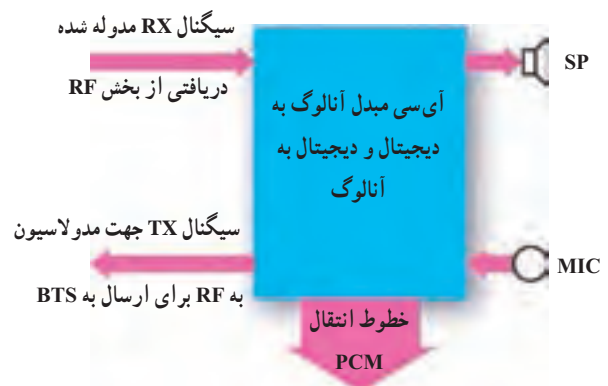
شکل ۱۹-۲۵- ورودی ها و خروجی های IC در بخش AF
