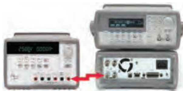
شکل ۱۷-۳- اتصال منبع تغذیه DC به ورودی VCO
