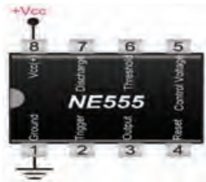
شکل ۴۱-۹- پایه ۵ آی سی با خازنی به زمین وصل می‌شود.
