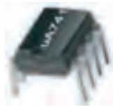
شکل ۹-۱۴- شکل ظاهری آی سی ۷۴۱
