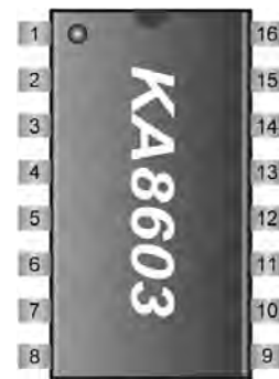
شکل ۱۹-۹- شماره پایه‌های آی‌سی
