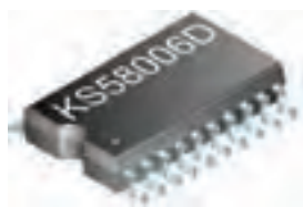
شکل ۱۴-۱۹ شکل ظاهری آی سی ۲۰ پایه
