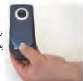
۳ با فشار کمی روی زائده یا دکمه قاب پشت، قاب را آزاد کنید.
