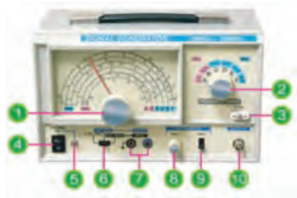
شکل ۱-۶-۱-۶ شکل ظاهری دستگاه مولد RF و کنترل‌های آن
