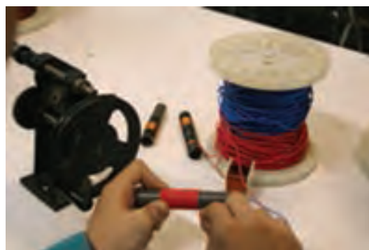
شکل ۹-۸- یک نمونه دیگر سلف 300\ \mu\text{H}
