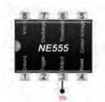
شکل ۹-۳۸- پایه خروجی آی‌سی
