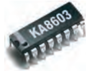
شکل ۱۹-۸- شکل ظاهری آی‌سی
