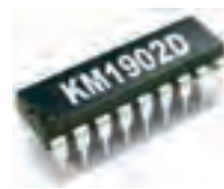
شکل ۱۳-۱۹ شکل ظاهری آی سی ۱۸ پایه
