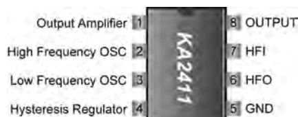
شکل ۱۹-۵ مشخصات پایه های آی سی
