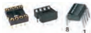
شکل ۹-۳۵- شکل ظاهری و سوکت آی‌سی NE ۵۵۵
