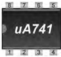
شکل ۹-۱۵- شماره پایه‌های آی سی
