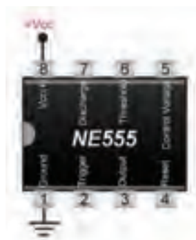
شکل ۹-۳۷- پایه‌های تغذیه آی‌سی
