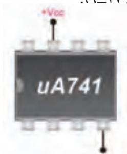
شکل ۹-۱۷- اتصال +V_{CC} و -V_{CC} به آی سی
