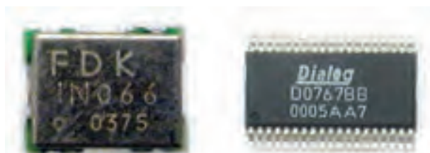
شکل ۱۹-۳۹- دو نمونه آی سی پاور (PA)
