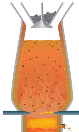
ب) گرما دادن مخلوط سنگ آهن، کربن و سنگ آهک ت) تولید ورقه‌های فلز آهن در کوره
