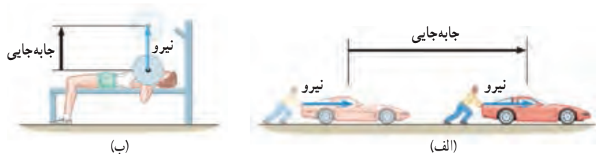
شکل ۲- انجام کار در دو حالت مختلف؛ توجه کنید که نیرو و جابه‌جایی در یک جهت‌اند.
