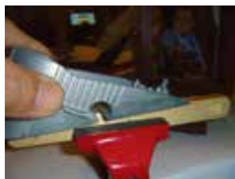
رنده کاری سطح زهوار با رنده ظریف
