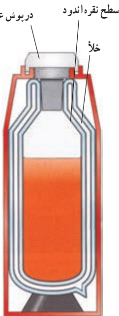
شکل ۱۳- فلاسک خلأ می‌تواند مدت نسبتاً زیادی دمای جسم را تقریباً ثابت نگه دارد.
