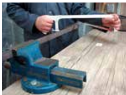
شکل ۱-۱۲- شکسته شدن تیغ اره
