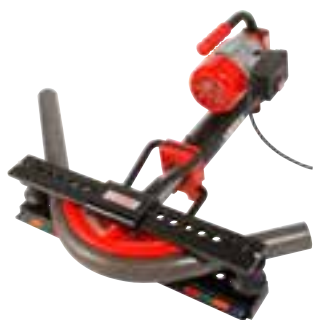
شکل ۲۴-۱- خم کاری با قالب
