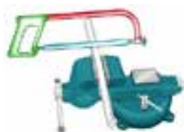
ج) بریدن لوله از روی خط
