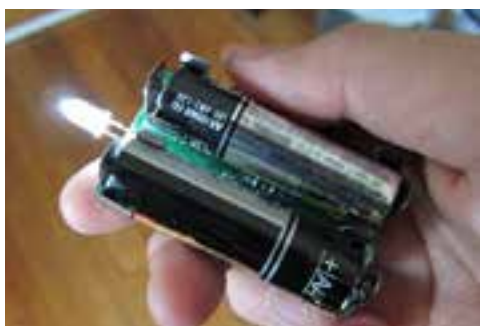
شکل ۲۳-۲- مدار عملی یک چراغ قوه با LED
