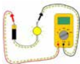
ب) اتصال سری مولتی متر اندازه گیری جریان
