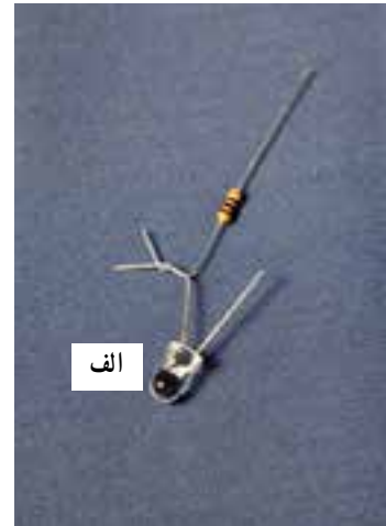
شکل ۱۹-۲- الف) اتصال دیود نوردهنده به یک مقاومت به صورت متوالی (سری) ، ب) علامت مداری دیود نوردهنده
