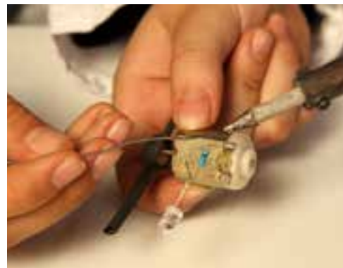
شکل ۲-۳۶- اتصال نامناسب قطب ها
