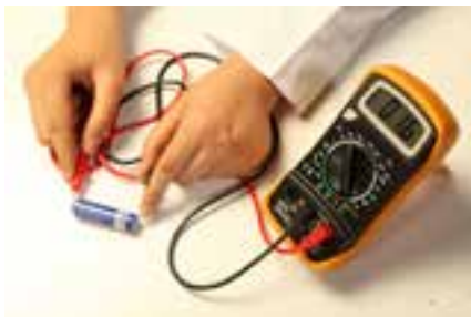
شکل ۲۸-۲- مقدار اختلاف پتانسیل الکتریکی يك باتری قلمی
