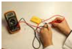
ب) اتصال سری مولتی متر اندازه گیری جریان
