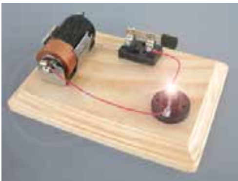
شکل ۲-۲- مدار عملی روشن و خاموش کردن یک لامپ
