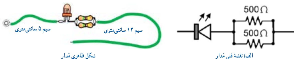
شکل ۴۷-۲- مدار کامل دیود انتشاردهنده نور
