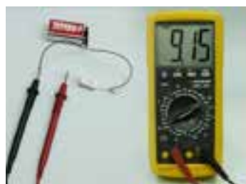
شکل ۳۱-۲- اندازه گیری شدت جریان مقاومت
