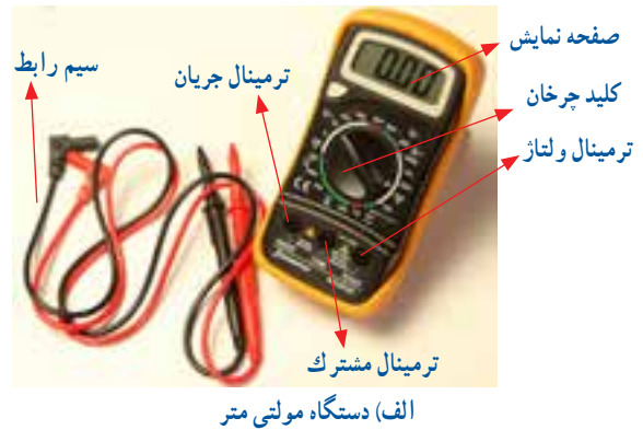
شکل ۲۷-۲- مولتی متر و اندازه‌گیری مقاومت الکتریکی
