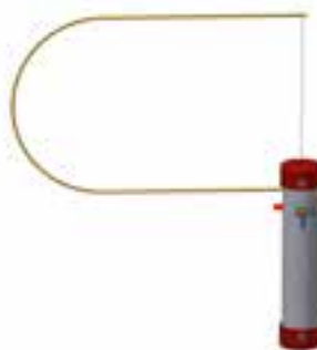
(الف) استفاده از دستگاه برش حرارتی بدون پایه
