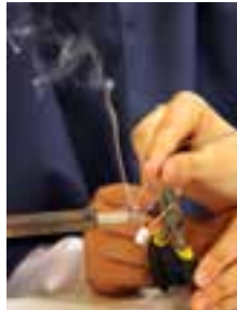
پ) اجرای لحیم کاری
