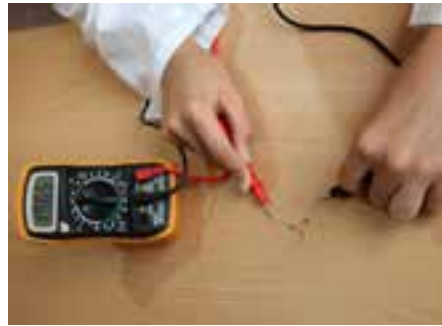
الف) دو مقاومت ۱۰۰ اهمی سری شده
