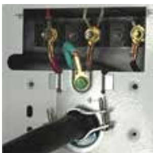
شکل ۸-۲- اتصال سیم ارت به بدنه دستگاه
