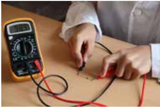
ب) اندازه‌گیری مقاومت ۱۰۰ اهمی
