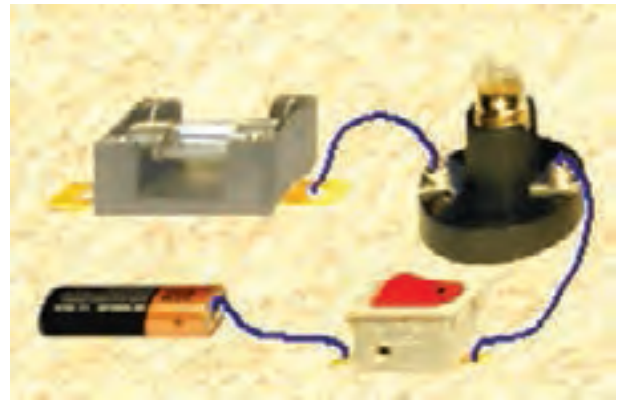
شکل ۱-۴۰ سیم متصل شده به باتری و کلید قطع شده و لامپ به حالت خاموش در آمده است.
