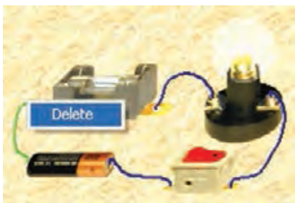
شکل ۱-۳۹ نحوه ی پاک کردن یا برداشتن سیم رابط
