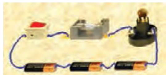
شکل ۱-۵۵ اصلاح مدار شکل ۱-۵۴ با استفاده از سه پیل
