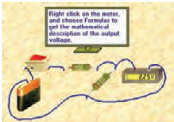
شکل ۱-۵۸ مدار تقسیم ولتاژ بین دو مقاومت
