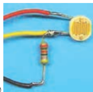
شکل ۱-۶۰- شکل ظاهری و نماد فنی مقاومت تابع نور LDR
