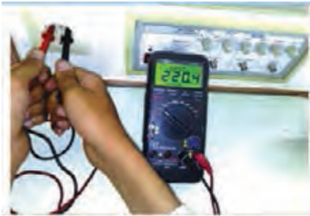
شکل ۲-۷۹ اندازه‌گیری ولتاژ برق شهر
