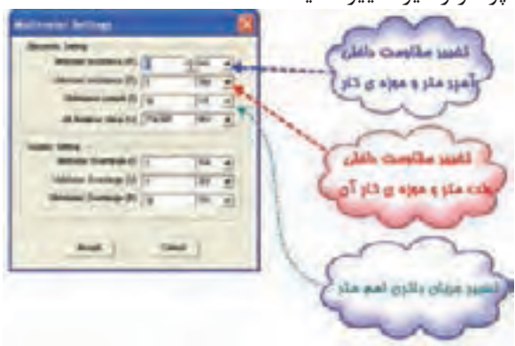
شکل ۲-۷۷ تنظیم دقت مولتی‌متر
