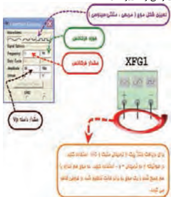
شکل ۸۰-۲ فانکشن ژنراتور و صفحه ی تنظیم آن
