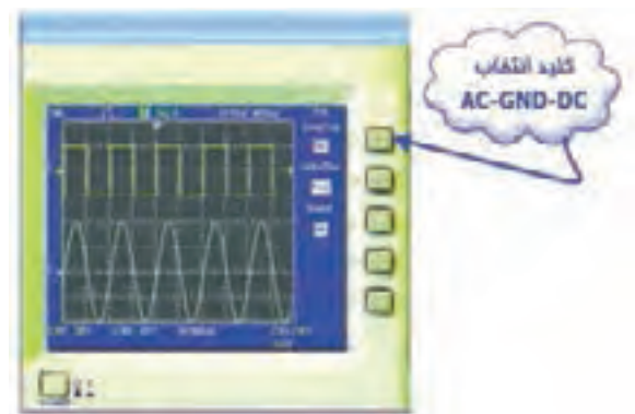
شکل ۲-۹۴ کلید انتخاب ورودی AC-GND-DC
