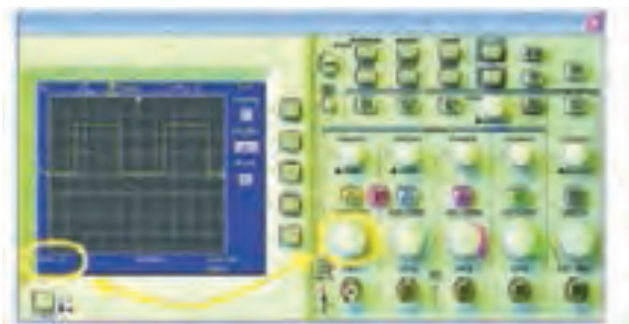
شکل ۲-۱۰۱ تغییر کلید نمایش عدد ضرب Volt/Div
