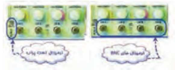
شکل ۲-۹۲ ترمینال تست پراب و کانال‌های ورودی دستگاه
