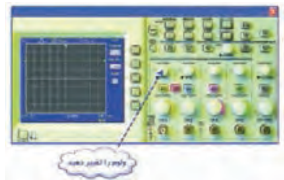
شکل ۲-۱۰۲ تغییر مکان عمودی خط GND
