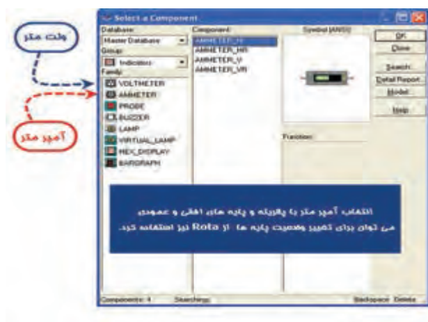
شکل ۲-۷۳ انتخاب آمپرمتر و ولت‌متر از منوی نشان‌دهنده
