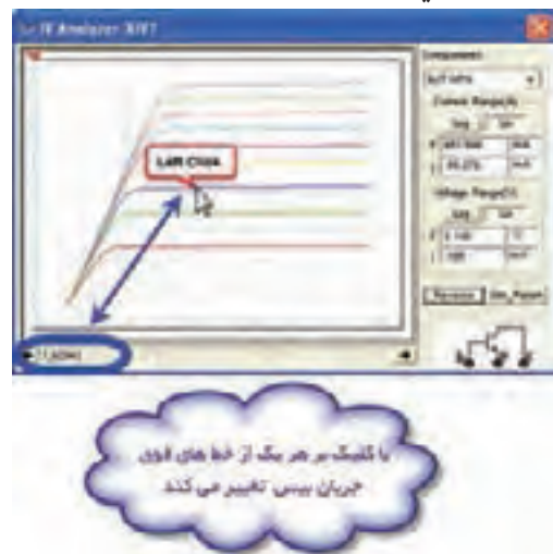
شکل ۱۳۳-۲ الف منحنی مشخصه‌ی ترانزیستور
