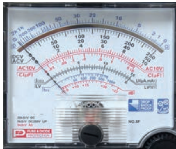
شکل ۲-۱۵- صفحه مدرج یک نمونه مولتی متر آنالوگ
