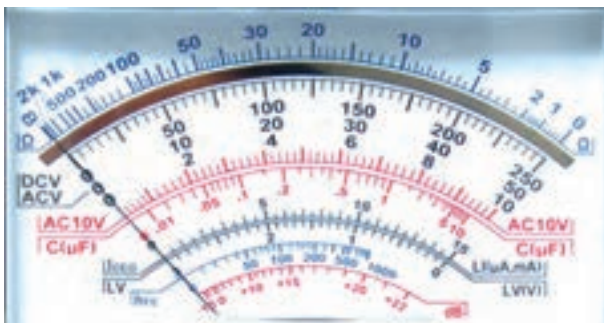
شکل ۲-۱۲- صفحه مدرج و علامت روی آن در مولتی متر آنالوگ
