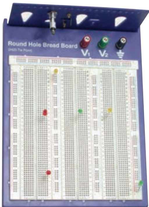
شکل ۹-۲- افزایش ابعاد و تعداد سوراخ‌های برد بُرد از طریق اتصال چند برد بُرد به یکدیگر
