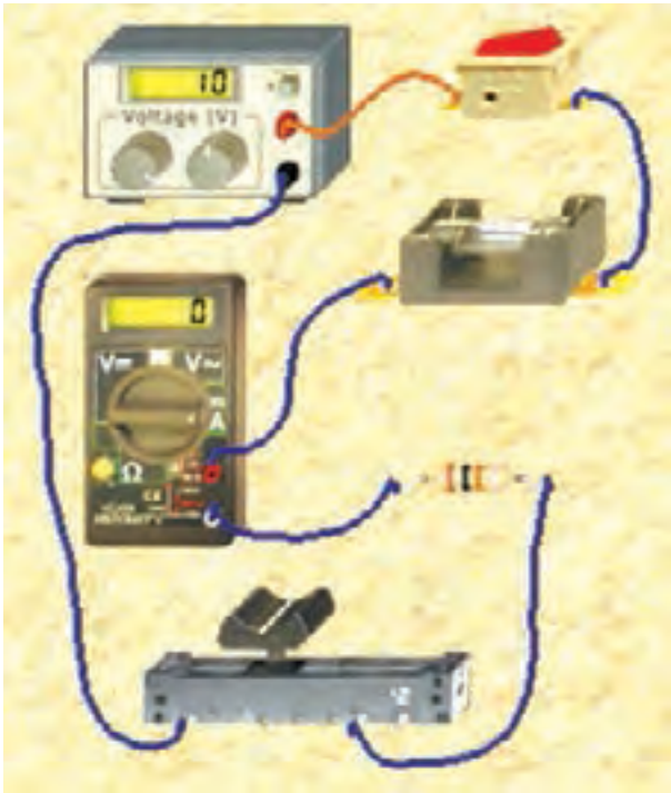
شکل ۱۵-۱ رعایت سه نکته‌ی ایمنی مهم در مداری که در آن پتانسیومتر قرار دارد
