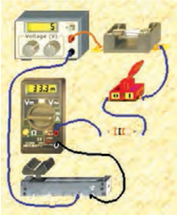
شکل ۱-۹ اتصال رئوستا در نرم افزار ادیسون
