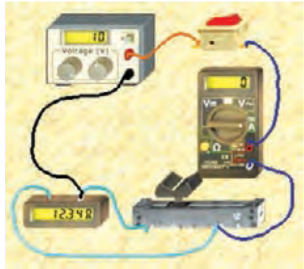
شکل ۱-۱۱ رعایت یکی از نکات ایمنی مهم هنگام اندازه‌گیری مقاومت
