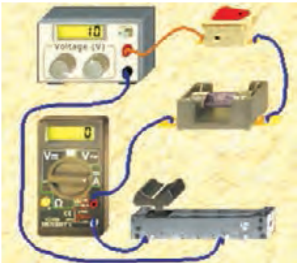
شکل ۱-۱۳ در مدار پتانسیومتر فیوز سوخته است.
