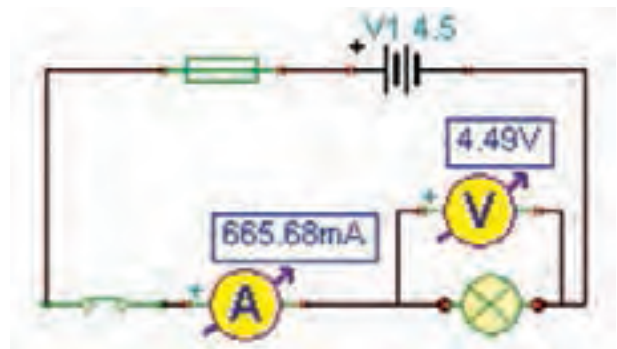
ب- نقشه ی فنی شکل ۲-۳ محاسبه ی توان مصرفی در لامپ با استفاده از مولتی متر
