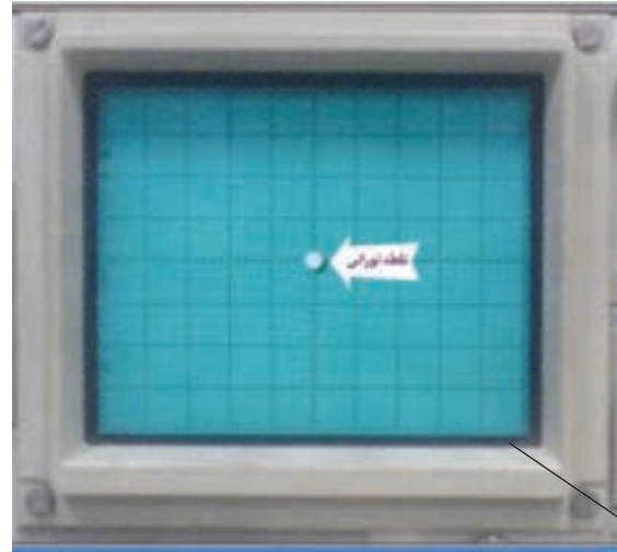
شکل ۵-۵ تولید نقطه نورانی به وسیله اشعه کاتدیک
