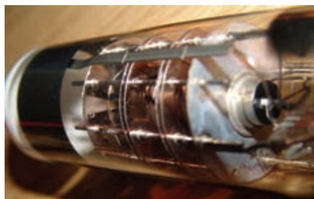
شکل ۴-۵. ساختمان داخلی تفنگ الکترونی
