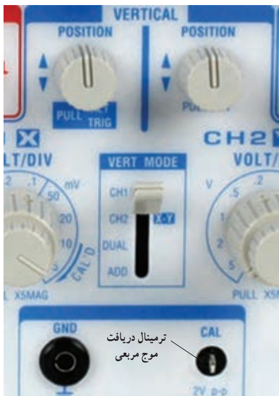
شکل ۱۸-۵- قسمت‌های مشترک و سایر تنظیم‌کننده‌های قسمت عمودی
