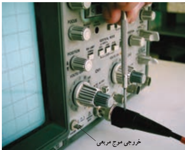
شکل ۵-۱۳ نحوه تنظیم پروب برای مشاهده موج مربعی
