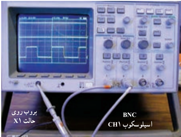
شکل ۵-۲۲- اتصال کانال یک اسیلوسکوپ به ترمینال خروجی مولد موج مربعی
