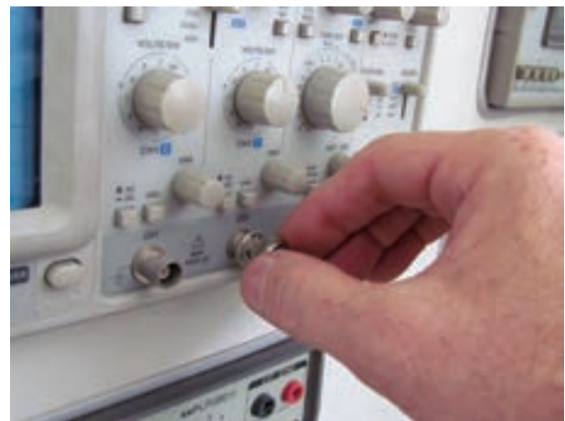
شکل ۵-۱۲ چگونه اتصال BNC به اسیلوسکوپ
