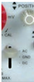
شکل ۱۶-۵- اتصال سیگنال AC به ورودی اسیلوسکوپ
