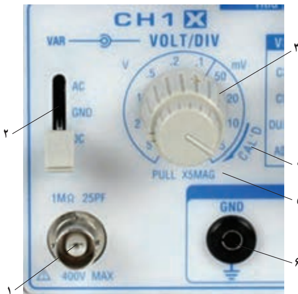
شکل ۱۴-۵- سلکتورها، ولوم‌ها و ترمینال‌های ورودی اسیلوسکوپ
