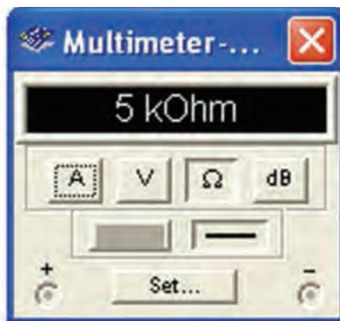
شکل ۳-۲ اندازه‌گیری مقاومت کل در مدار سری
