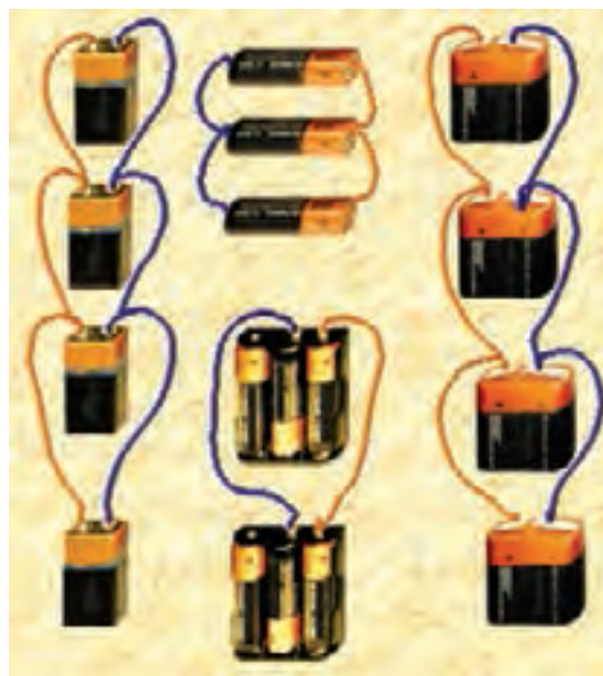
شکل ۵-۱۳ اتصال موازی پیل‌ها و باتری‌ها
