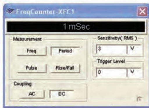
شکل ۶-۷ استفاده از فرکانس متر در اندازه‌گیری زمان تناوب
