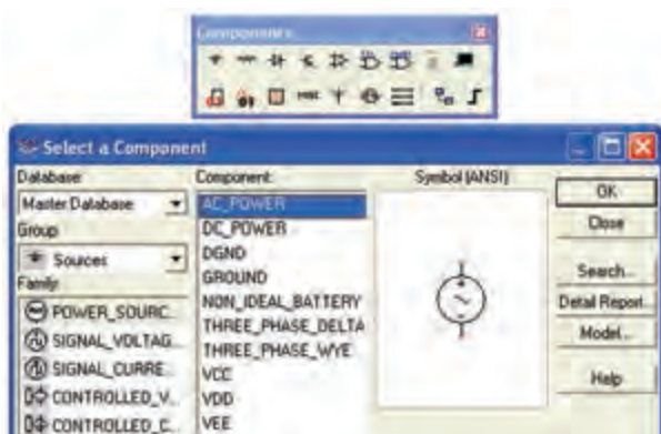
شکل ۶-۱ نحوه‌ی قرار دادن فانکشن ژنراتور و منبع AC بر روی صفحه‌ی کار
