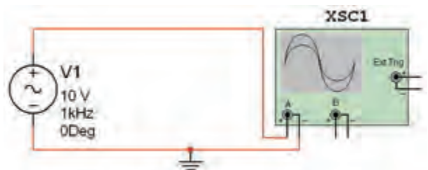
شکل ۹-۶ الف- نحوه‌ی اتصال اسیلوسکوپ به منبع
