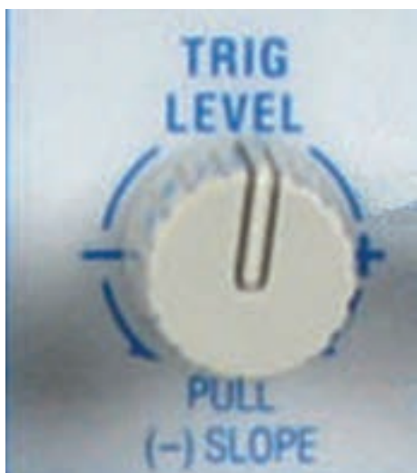
شکل ۱-۶- ولوم Level و Slope
