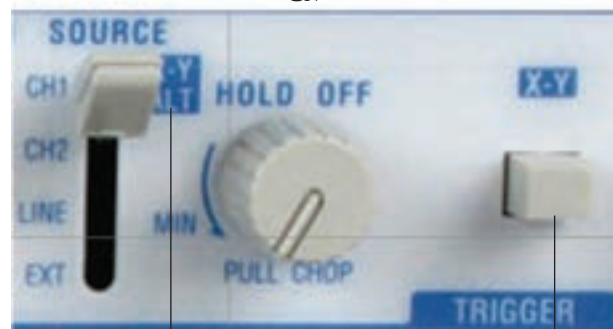
شکل ۶-۱۲ – کلیدهای مرتبط با حالت x-y روی یک نمونه اسیلوسکوپ
