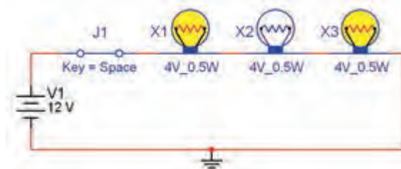
شکل ۱-۱۶ تاثیر اتصال کوتاه یک لامپ در مدار سری
