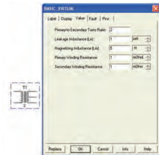
شکل ۱-۴۳ تنظیم نسبت ترانسفورماتور
