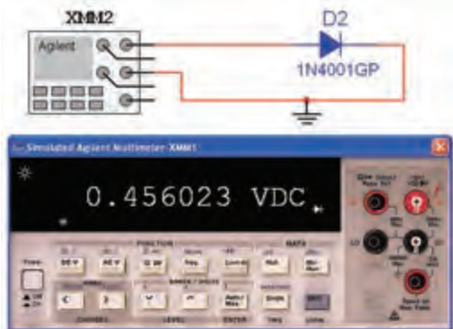
شکل ۲-۲۱ آزمایش دیود در بایاس موافق
