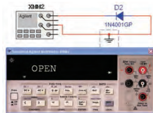
شکل ۲-۲۲ آزمایش دیود در بایاس مخالف
