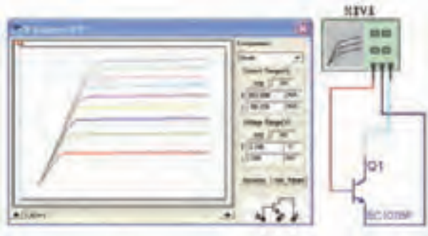
شکل ۴-۱۶ منحنی مشخصه خروجی ترانزیستور
