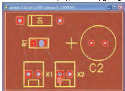
شکل ۳-۳۲ شبکه‌ی کامل Net برای مدار چاپی یکسوساز نیم‌موج
