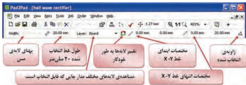
شکل ۳-۵ مشخصات زبانه‌های مربوط به نوار تعیین ابعاد
