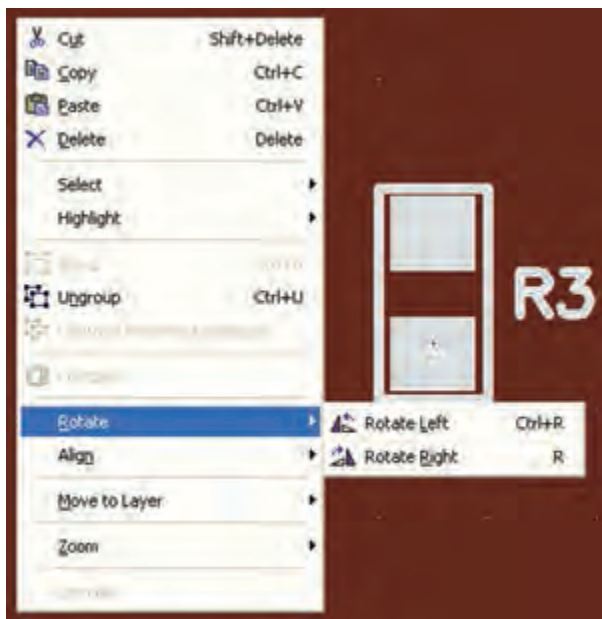
شکل ۳-۲۱ چرخاندن قطعه روی فیبر
