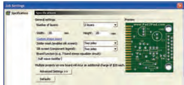
شکل ۳-۱ انتخاب مشخصات فیبر مدار چاپی
