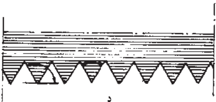
د زاویه‌ی برش 120^\circ درجه زاویه‌ی دندانه‌ی 60^\circ درجه تیغه‌ی ازه‌ی مناسب برای برش‌های ظریف
