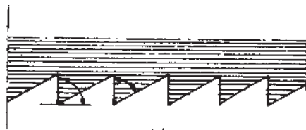
ب زاویه‌ی برش 90^\circ درجه زاویه‌ی دندانه‌ی 50^\circ تا 60^\circ درجه تیغه‌ی ازه‌ی مناسب برای برش‌های عرضی و طولی
