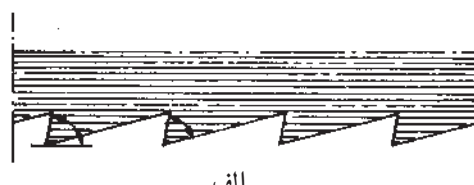
الف زاویه‌ی برش 80^\circ درجه زاویه‌ی دندانه‌ی 40^\circ تا 50^\circ درجه تیغه‌ی ازه‌ی مناسب برای برش‌های طولی
