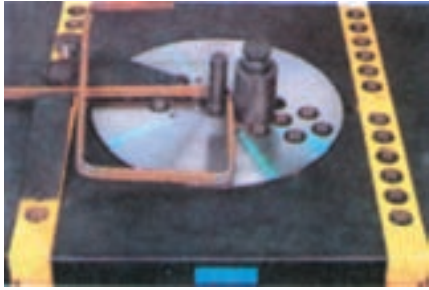
شکل ۶۷-۲- دستگاه خاموت خم کن برقی
