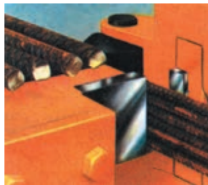
شکل ۵۶-۲- یک نمونه ماشین برقی برش میل‌گرد
