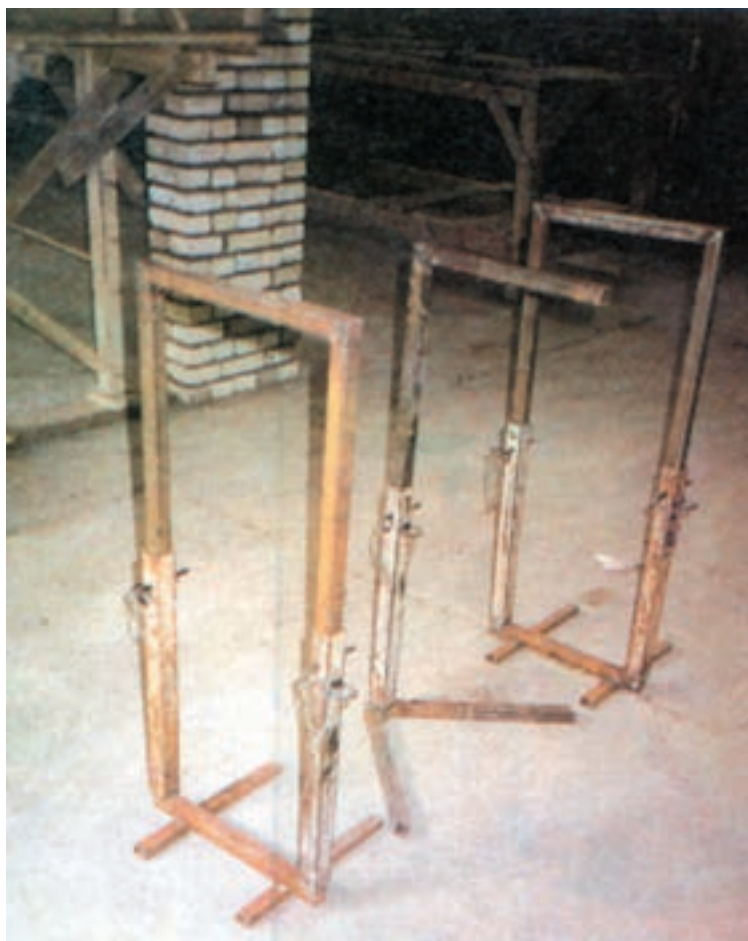
شکل ۹۴-۲- خرک های فلزی برای مونتاژ میل گرد
