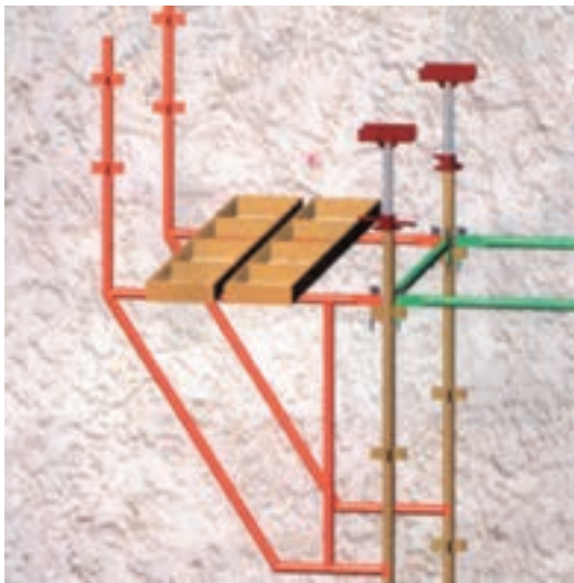
شکل ۷-۴۵ - سکوی کار برای داربست فلزی
