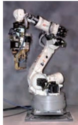
(ت) روبات جوشکار، جوش مقاومتی
