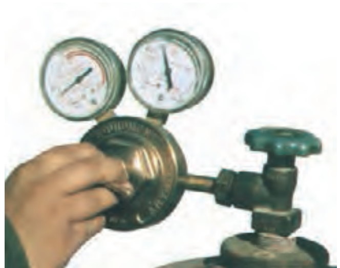
شکل ۱۱-۲- ب - نمای رگلاتور یک مرحله ای
