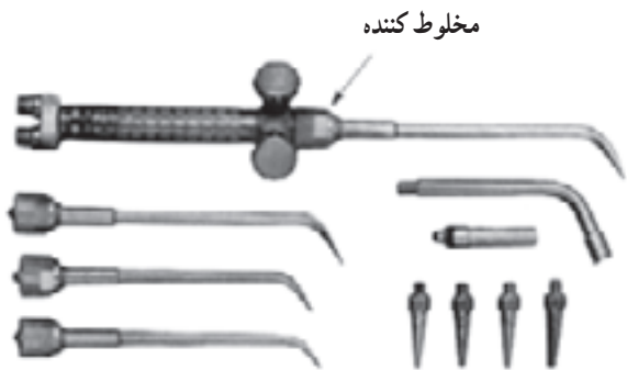
شکل ۱۵-۲- مشعل جوشکاری انژکتوری با سربک‌های یک تکه و دو تکه
