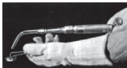
شکل ۲-۳- طریقه روشن نمودن مشعل
