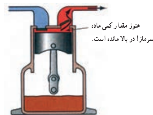
شکل ۳-۷- پیستون در نقطه مرگ بالا
