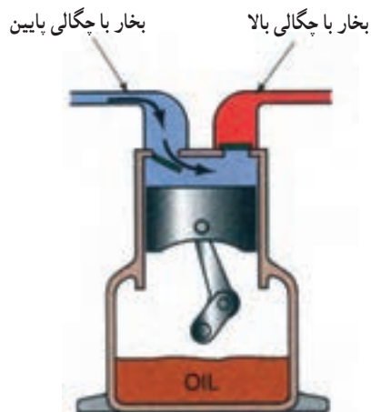
شکل ۳-۴- پیستون رو به پایین حرکت می کند.
