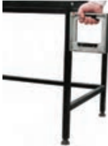
شکل ۲-۲- کنترل شیب پایه‌ی میز
